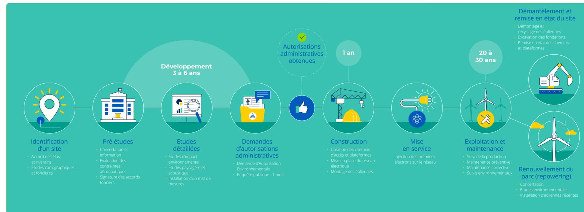
Figure 2 - Étapes de développement d'un parc éolien (ERG Développement France)
